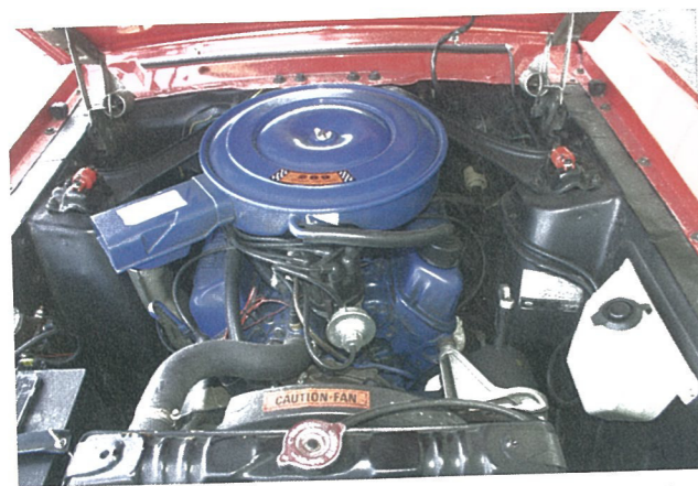
Weit verbreitet und weitgehend problemlos: V8-Motoren 289er-Small-Block war einer der populärsten im Mustang. Sein guter Ruf ist nie verhallt.
