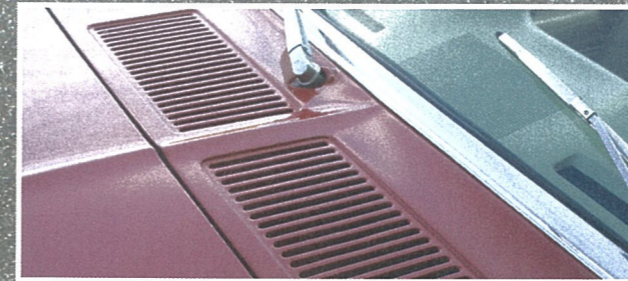
Hier Wasser hineinleeren. Wenn es in den Fussraum tropft, sind die «Coils» im Wasserkasten hin. Dann wirds aufwändig.
