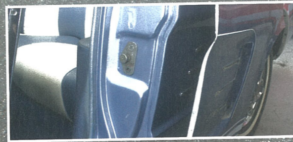
Typisch USA: Rechts im Bild ein herausgeschnittenes Seitenteil eines anderen Mustangs – das Weisse ist zentimeterdicker Spachtel!
