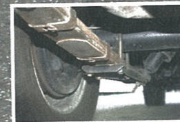
Lahmende Blattfedern lassen die Mustangs mitunter hängen.
