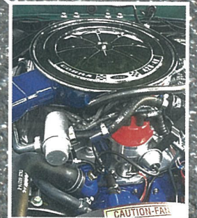
Bei den Motoren machen bisweilen schlecht gewartete Big Blocks Probleme (im Bild ein 428er).
