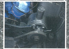
Falls eine Servolenkung vorhanden ist, sollte sie auf Lecks untersucht werden.
