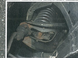
Quietschen beim Einfedern verheisst fehlende Federunterlagen oder trockene Querbolzen.
