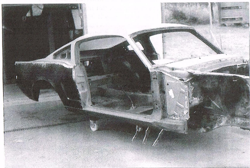
Aufatmen: die Schweissarbeiten sind grösstenteils abgeschlossen
