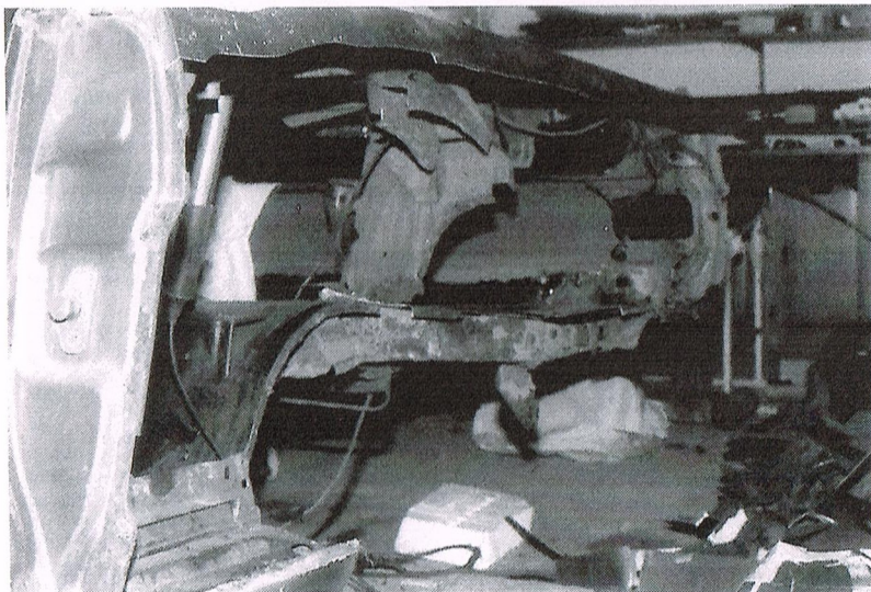
Ungewöhnliche Einblicke in den Kofferraum: Hintere Seitenwand, inneres/äusseres Radhaus und ein Teil des Kofferraumbodens fehlen
